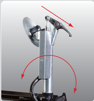
1 Disco tangente con la llanta (inclinación mínima).
